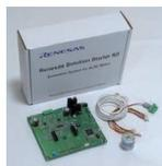
用于无刷直流电机 + CPU 卡的评估系统
